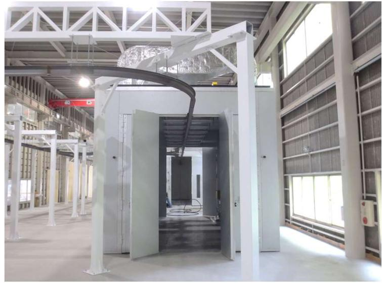
湿式大型局所排気装置 フード内寸法 幅6200×長さ1715×高さ3300
