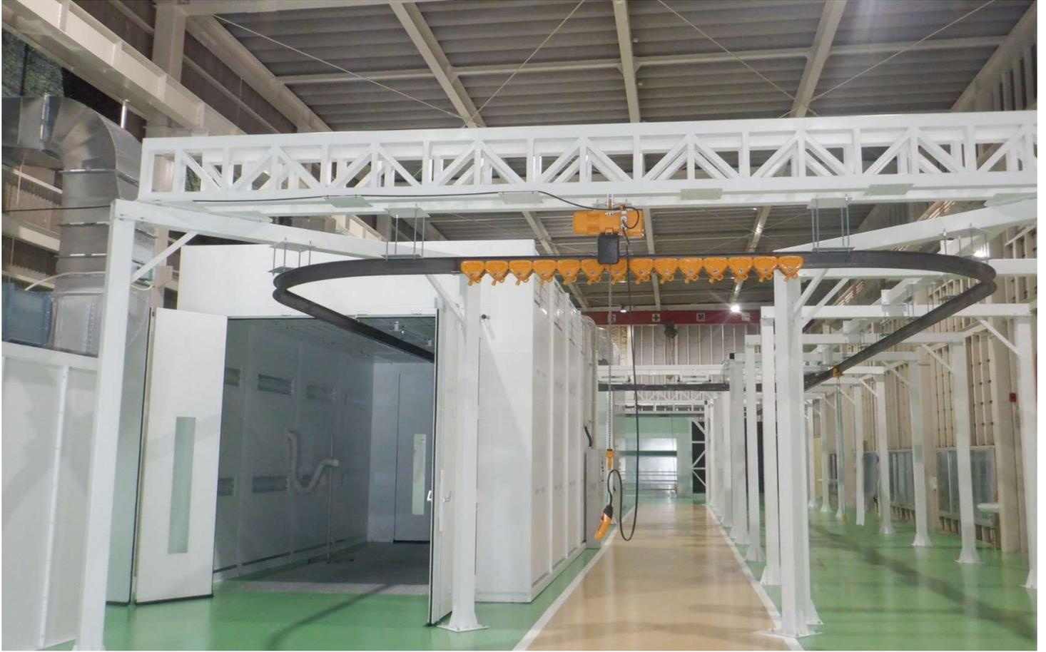
トロリーレールはエアシリンダーでの切り替えができるので、ワークの流れを塗装ブースでの周回や乾燥炉での周回など作業内容で切り替えて使えます。
