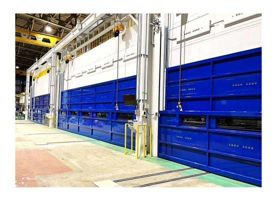
正面の出入り口には、幅が約11mもある電動扉を採用しており、作業台車の進入と同時に開閉します。
