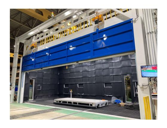
側面扉はスライド扉になっており、ブラスト処理の完了後に自動で扉開閉されます。 隣の塗装・乾燥ブースには天井クレーンでワークを移動させることが出来ます。
