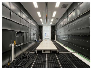
ブラストブースは室内壁に耐磨ゴムを付けることでブラス玉による劣化を防ぎます。 耐磨ゴムは交換可能な構造になっており、室内の照明は調光式仕様にしてあるので ワークの作業範囲を明るさ調整で確認しやすくなっています。
