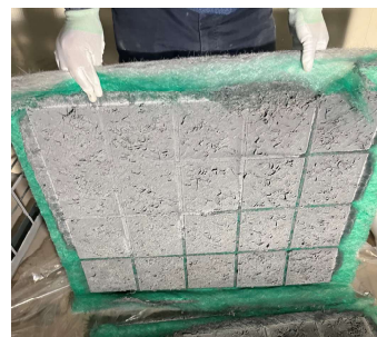
(排気フィルターへのミスト付着)
